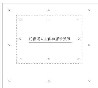
图 6.3.2.5 门窗洞口加密对拉螺栓
